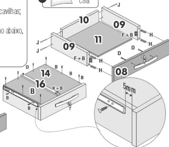
É indispensável fixar a corredeça na lateral, com recuo de 5 mm em relação a frente da gaveta, para acionar a trava da corredeça.
