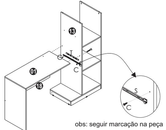
**5º** Montar suporte traseiro **14** sobre tampo **1**, usar cavilha **O**. Fixe prateleira **15** no suporte **14** usar parafuso **N**, na lateral **13** usar parafuso **H**. Monte tampo **4** sobre suporte **14** e laterais **5** e **13** usar mini fix **B** e **D**.
