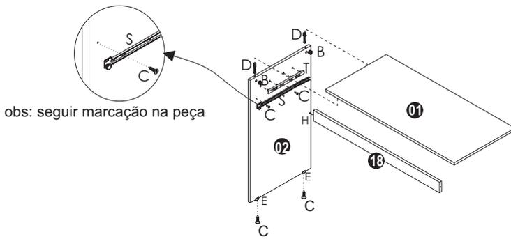
**4º** Fixar corredeiras **S** e **T** na lateral **13**, utilizar parafusos **C** para corredeira **S**. Unir módulos montados passo 2 e 3, parafusando tampo **1** e **18** na lateral **13** usar parafusos **H**.
